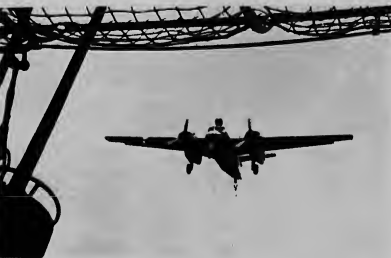
Un Tracker ta drentando, y ta saca e haak patras. (manera nos por mira claramente). E portret a worde saca door di e buraconan di e dek cubierta, e aparato nos ta mira anto di banda abou, algun seconde promé cu e topa cu e pista di avionnan.
